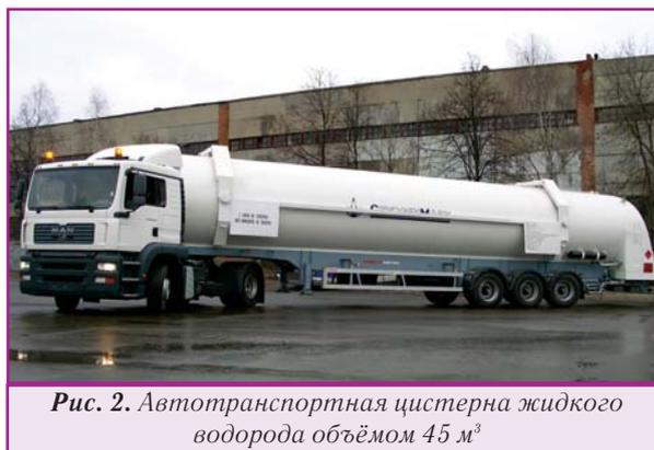
**Рис. 2.** Автотранспортная цистерна жидкого водорода объёмом 45 м<sup>3</sup>
