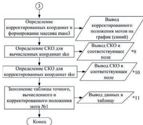
Рис. 5. Блок-схема алгоритма позиционирования (ч. 4)
