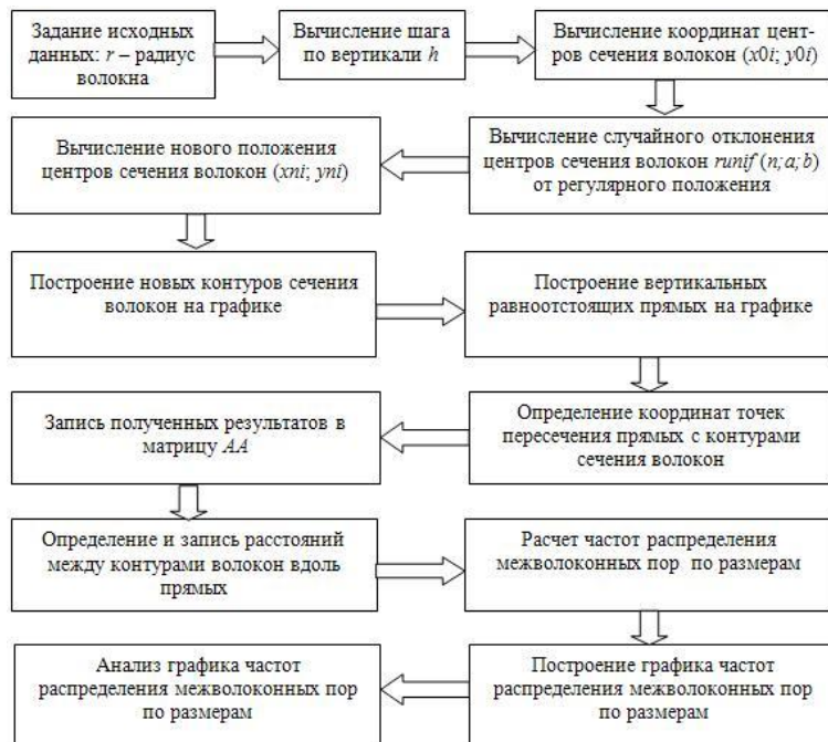
Рис. 4. Схема алгоритма вычисления межволоконных пор по размерам в компьютерной модели структуры нити
