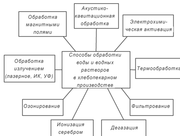
Рис. 2. Способы обработки воды и водных растворов в хлебопекарном производстве
