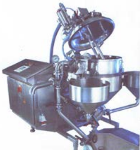
Рис. 4. Вакуум-виробнича установка для рідких і пастоподібних продуктів [12]
