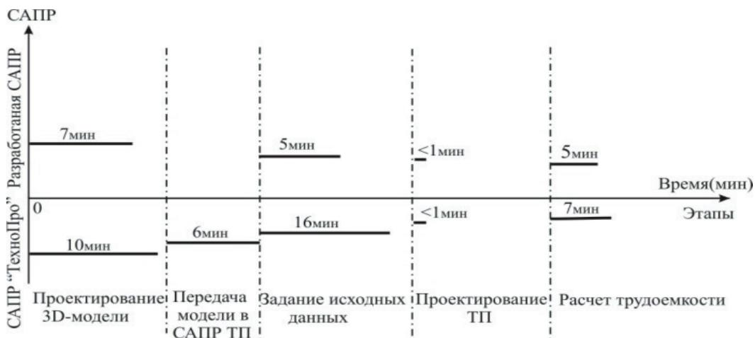
Рис. 6. Диаграмма времени разработки детали типа «Вал»
