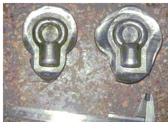
Рис. 9. Сравнение поковок с облоем, отштампованных с профилированием заготовки продольным изгибом (слева) и по базовому варианту (справа)
