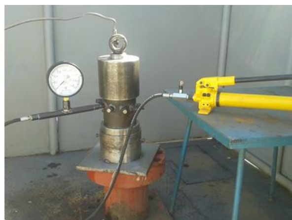
Рис. 2. Лабораторний стенд для дослідження контактних тисків: а – принципова схема лабораторного стенду: 1 – ствол пакера; 2 – опорна втулка; 3 – самоущільнювальна манжета; 4 – упор; 5 – упорна гайка; 6 – патрубок; 7 – нижня кришка; 8 – упорний стакан; 9 – стопорні гвинти; 10 – рим-болт; 11 – верхня кришка; 12 – вхідний отвір для підводу випробувальної рідини; 13 – радіальний випробувальний отвір; 14 – запобіжний штуцер; 15 – контрольний манометр; 16 – зворотний клапан; 17 – ручний гідравлічний насос; 18 – зливний отвір; б – загальний вигляд лабораторного стенду
