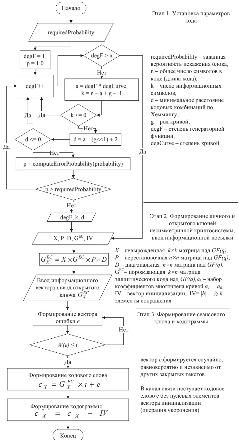
Рис. 4. Алгоритм формирования кодограммы в модифицированной НККС Мак-Элиса с укороченным модифицированным кодом
