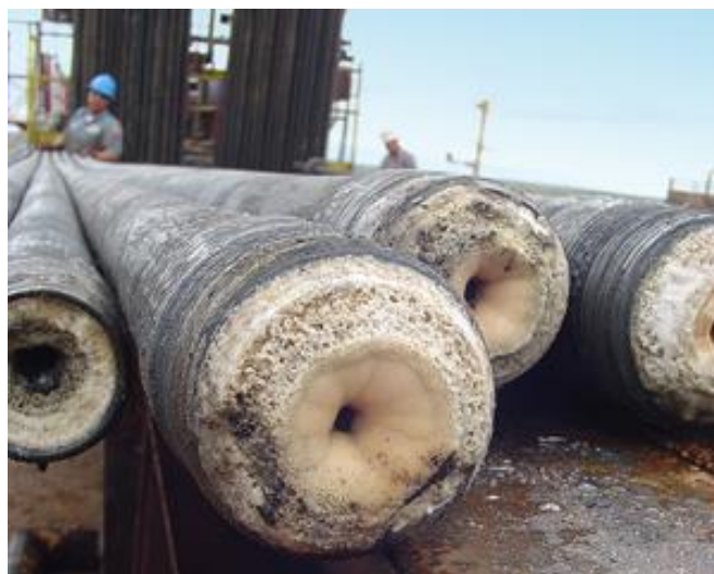
Рис. 1. Сольові відкладення в експлуатаційних колонах
