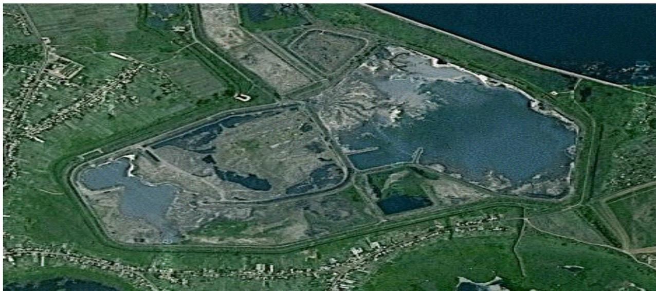
Рис. 4. Общий вид золошлакоотвала Змиевской ТЭС (аэрофотоснимок)
