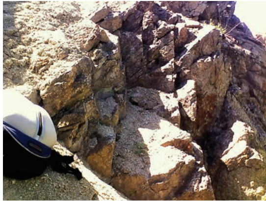
Рис. 3. Соотношение разрывов, принадлежащих к группам 1 (вертикальные) и 5 (пологопадающие под углом 30—35°). На последних — милонитовая пленка. Жевановский карьер, юго-западная стенка.
