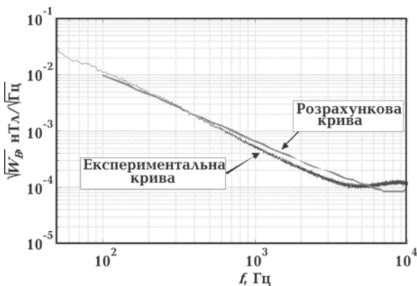
Рис. 5. Порівняння розрахункової (1) та експериментальної (2) залежності РШ.
