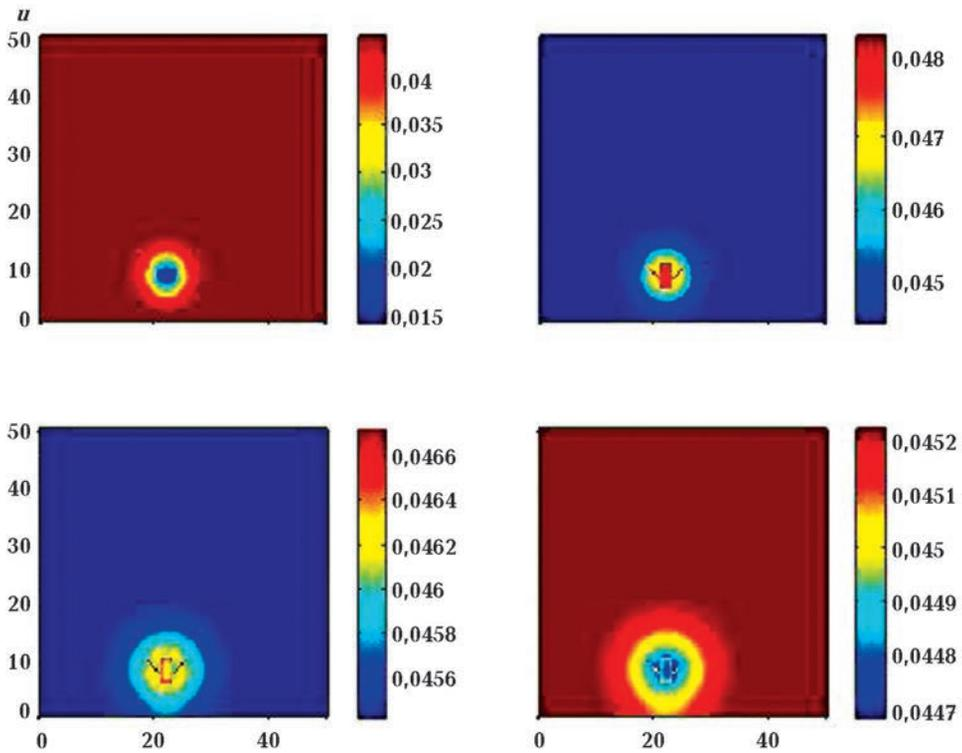
Рис. 6. Расчетная динамика СА для модели (1). Временной интервал  $\Delta T = 10$ , значения параметров:  $a=6$ ;  $d=0,12$ ;  $D=0,5$ ;  $i_0=0,2$ ;  $\sigma=4$ ;  $\epsilon_0=0,05$ ;  $\delta_\epsilon=0,62$ ;  $c_1=0,01$ ;  $c_2=0,1$ ;  $u_1=-0,04$ ;  $u_2=0,75$ . Начальные данные:  $u_x=0,05$ ,
