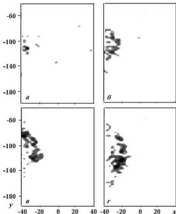
Рис. 3. Пространственное распределение плотности числа акустических событий в эксперименте АЕ42, зарегистрированных в слое  $-3\text{ мм} \leq Z \leq 3\text{ мм}$  в течение временных интервалов  $14250\text{ с} \leq t \leq 14300\text{ с}$  (а),  $14550\text{ с} \leq t \leq 14600\text{ с}$  (б),  $14850\text{ с} \leq t \leq 14900\text{ с}$  (в),  $15200\text{ с} \leq t \leq 15250\text{ с}$  (г). Более темный цвет означает большую плотность событий [Тюпкин, 2001].
