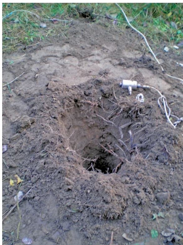
Рис. 4. Воронка, що утворилась унаслідок вибуху імпульсного джерела на основі газової детонації.
