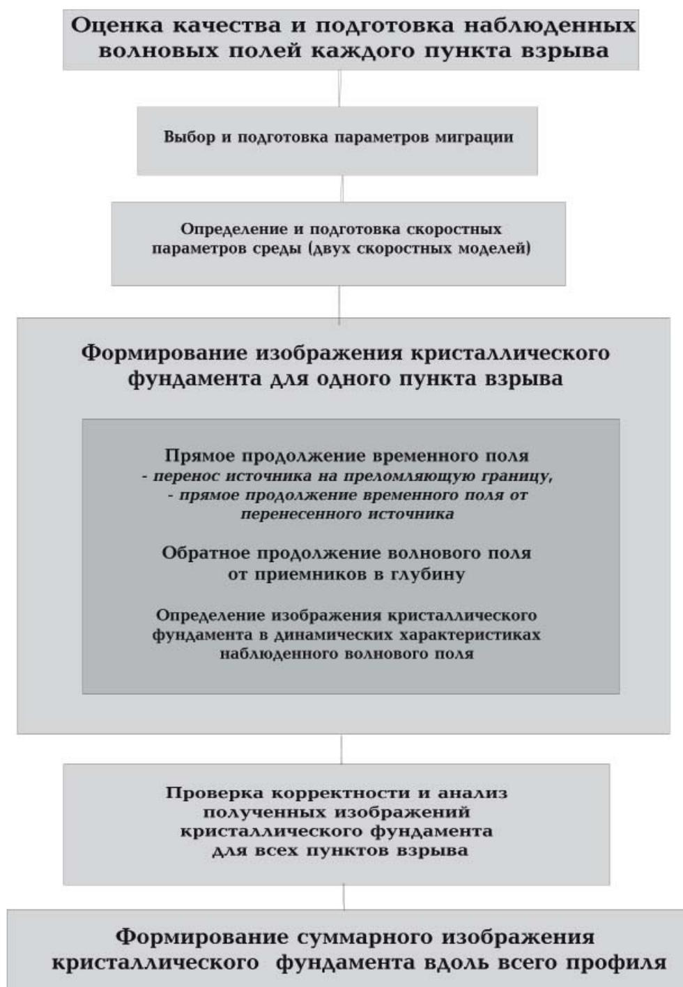
Рис. 3. Блок-схема алгоритма формирования изображения кристаллического фундамента с применением конечно-разностной миграции поля отраженных/рефрагированных волн.
