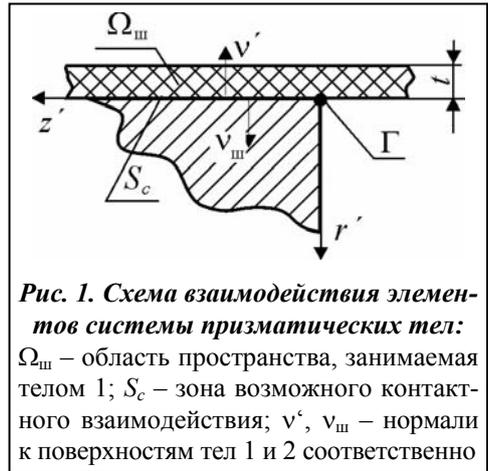
Рис. 1. Схема взаимодействия элементов системы призматических тел:  $\Omega_{ш}$  – область пространства, занимаемая телом 1;  $S_c$  – зона возможного контактного взаимодействия;  $v'$ ,  $v_{ш}$  – нормали к поверхностям тел 1 и 2 соответственно
