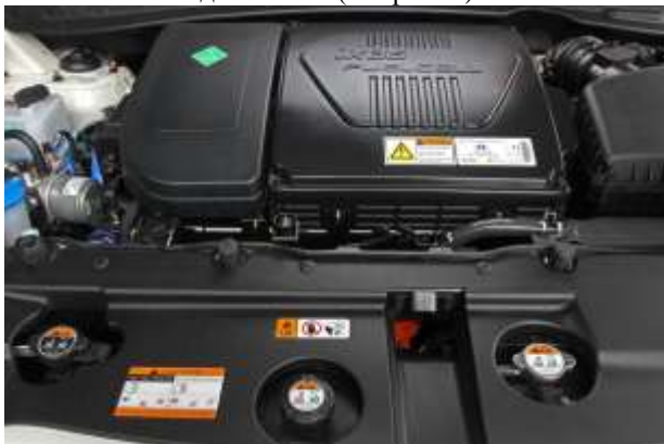
Рисунок 2 – Топливный элемент подает ток на литийно-полимерный аккумулятор, затем ток подается на электродвигатель в 136 лошадиных сил
