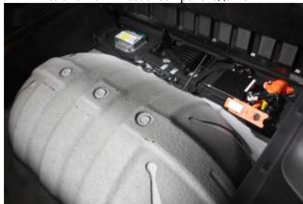
Рисунок 3 – Один из двух баков с водородом, находящихся под днищем автомобиля
