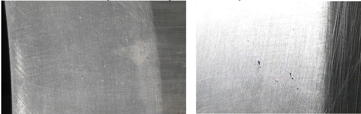
Рис. 1 – Раковини на біговій доріжці зовнішнього кільця дворядного роликівого підшипника
