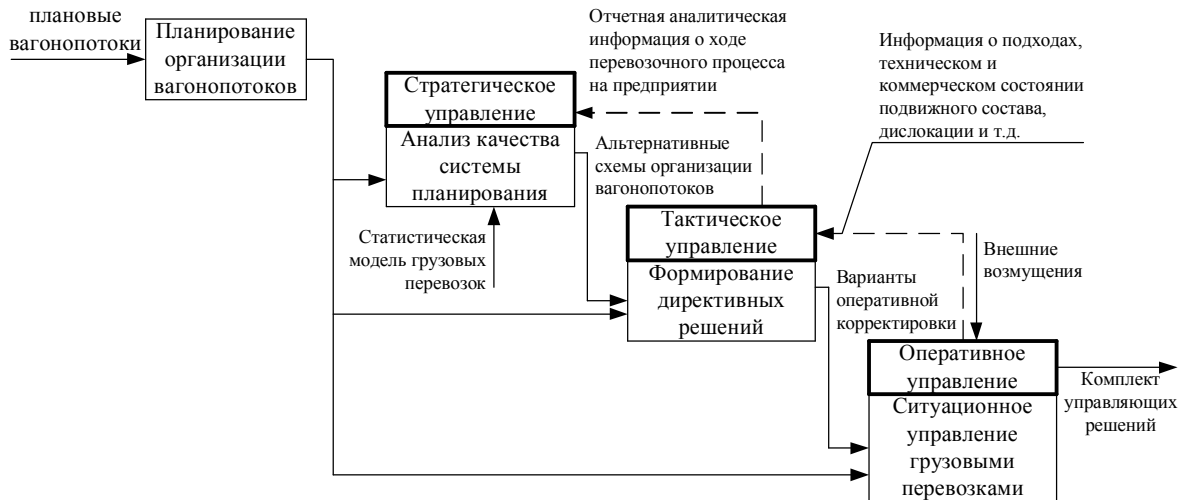
Рис. 2 – Функциональная структура единой модели управления вагонопотоками промышленного предприятия.
