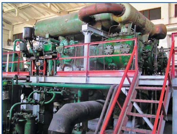
**Фото 1.** Внешний вид компрессора 6ВМ16-140/200М1, работающего в составе ВРУ на «Харьковском автогенном заводе» (год выпуска — 1989)
