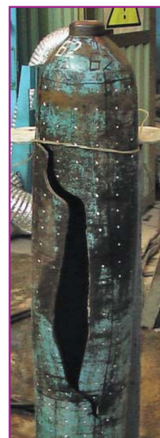
Фото 1. Разрушение баллона при его освидетельствовании
