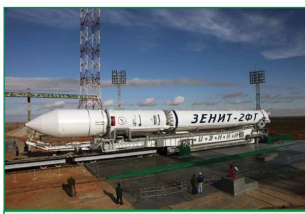
Рис. 1. Ракета-носитель «Зенит» на транспортном устройстве
