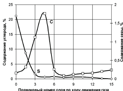
Рис. 4. Зависимость массового содержания углерода и серы в слоях составного образца (КШ) после фильтрации через него неочищенного колошникового газа при температуре 500^{\circ}C
