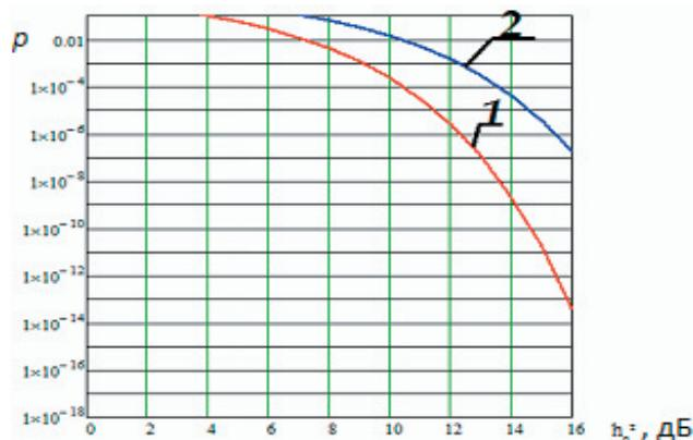
Рис. 2. Зависимость вероятности ошибки бита от ОСШ в канале с МСИ при использовании парциального кодирования
