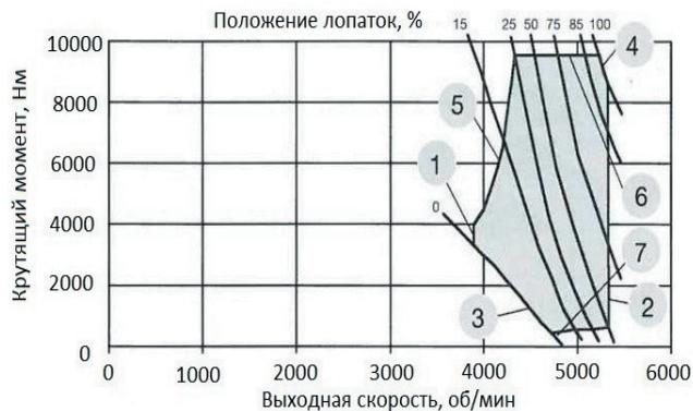
Рис. 7. Рабочая характеристика гидромуфты Vogeson
