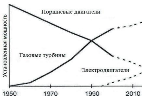
Рис. 1. Приводные машины для центробежных турбокомпрессоров на НПЗ
