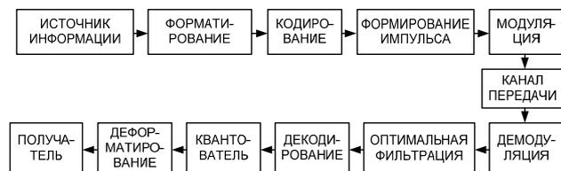
Рис. 1. Структурная схема исследуемой цифровой системы передачи информации
