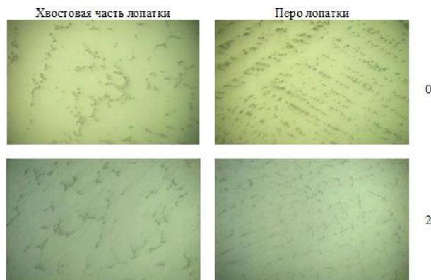
Рис. 2. Нетравленная структура исследованных лопаток × 100: 0 – без проведения операции ГИП; 2 – после проведения операции ГИП и термической обработки
