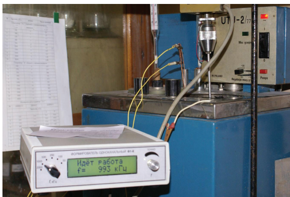
Рис. 1. Генератор импульсов тока и его подключение к акустическому волноводу посредством петли магнитного диполя
