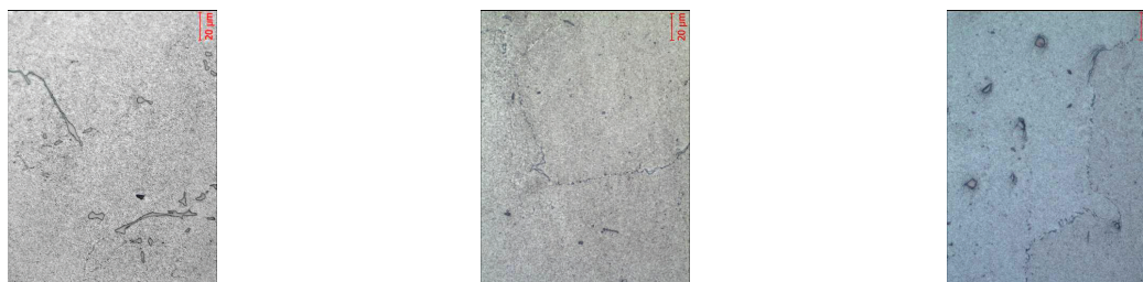
Рис. 4. Нетравленная структура образцов из сплава ЖСЗДК-ВИ, изготовленных по различным вариантам с применением операции ГИП, × 200
