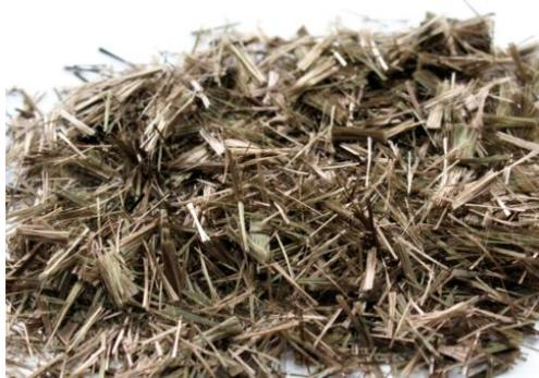
Fig. 2. Basalt fiber
