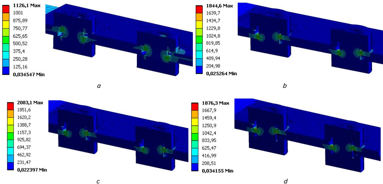
Fig. 16. Maximum equivalent Mises stresses (Fig. 6, c): variant 3\_1 (a); variant 3\_2 (b); variant 3\_3 (c); variant 3\_4 (d)
