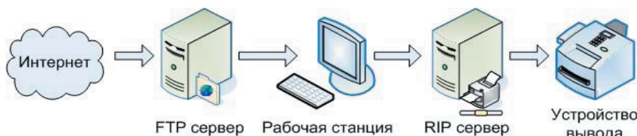
Рис. 1. Схема информационного потока на допечатном этапе
