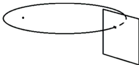
Рис. 1. Схема сечения средней орбиты потока плоскостью
