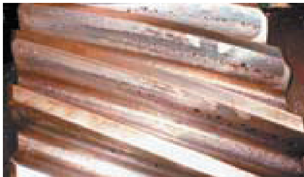
Рис. 1. Состояние активных поверхностей зубьев при наличии прогрессирующего выкрашивания
