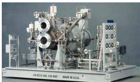
Рис. 5. Примеры использования магнитных подшипников в ДКА: а) первый турбодетандер с АМП; б) агрегат GE Rotoflow с АМП S2M
