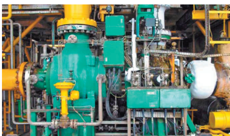
Рис. 5. Примеры использования магнитных подшипников в ДКА: а) первый турбодетандер с АМП; б) агрегат GE Rotoflow с АМП S2M
