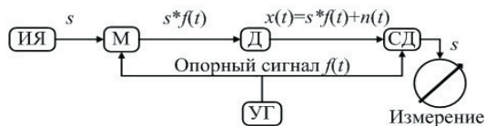
Рис. 4. Схема измерения сигнала при помощи синхронного детектирования
