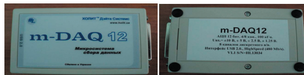
Рис. 5. Микросистема сбора данных m-DAQ 12 : а – вид сверху; б – вид снизу
