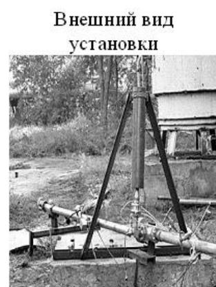
Рис. 2. Экспериментальная установка: 1 - гидроударный клапан; 2 - питательный трубопровод; 3 - насадка; 4 - пневмогидроаккумулятор; 5 - запитывающая магистраль; 6 - сливной трубопровод; 7 - вентиль; 8 - датчики давления; 9 - преобразователь; 10 - осциллограф; 11 - расходомер; 12 - емкость для воды; 13 - баллонная батарея; 14 - редуктор давления; 15 - манометр; 16 - заправочная горловина; 17 - запорный вентиль
