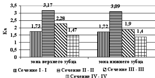
Рис. 7. Эффективные коэффициенты концентрации напряжений в расчетных сечениях хвостовика
