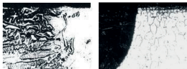
Рис. 2. Микроструктура сварного соединения стали 12X18H10T после пребывания в 30% \text{H}_2\text{SO}_4 : а - аэрированные (x 200); б - озонируемые (x 100) растворы
