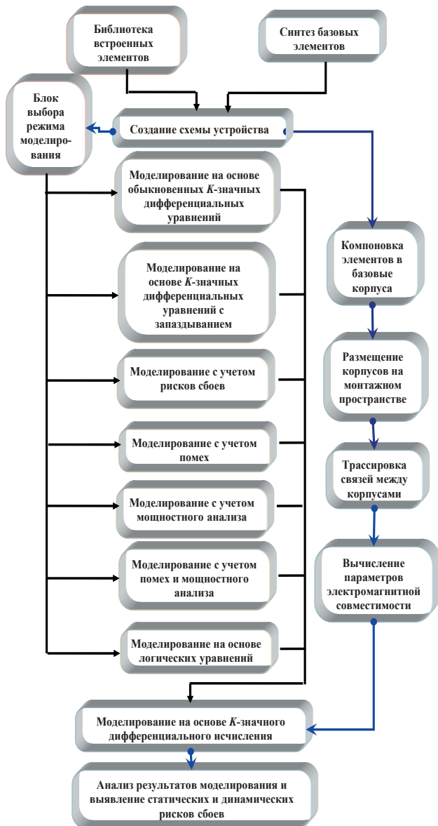
Рис. 1. Сеанс моделирования устройства с учетом электромагнитной совместимости
