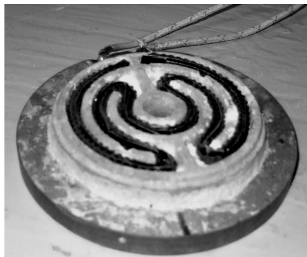
Рис. 1. Внешний вид образца в каналах электроплитки
