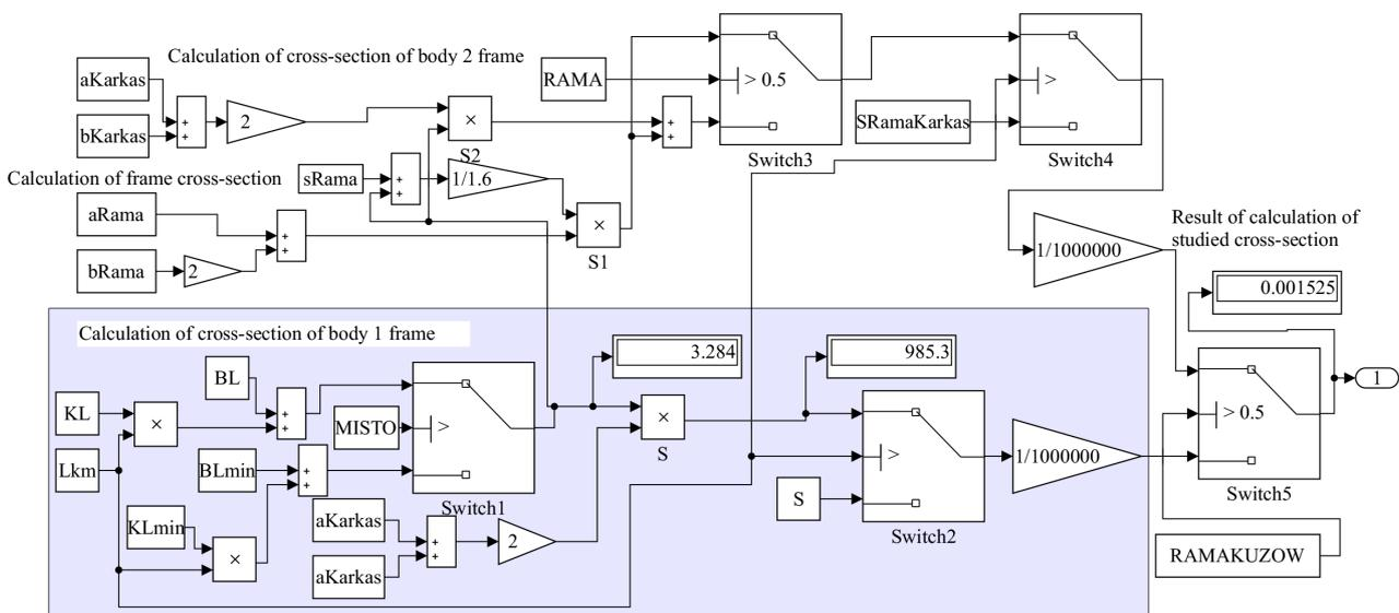
Fig. 4. Implementation of the subroutine «Subsystem 2» in Matlab Simulink
