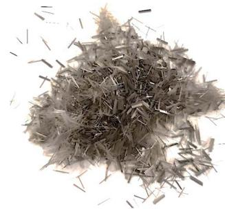
Fig. 1. Basalt fiber
