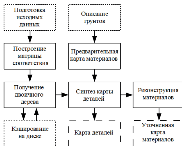
Рис. 1. Процесс синтеза карт материалов и деталей
