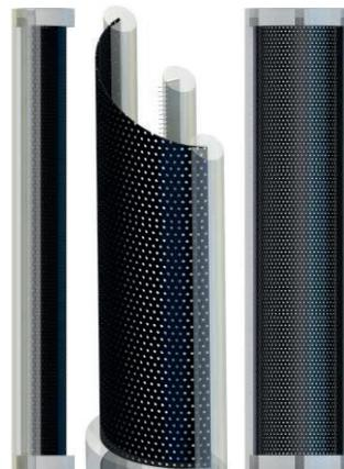
Рис. 1. Ионный громкоговоритель: вид сбоку, изометрия с местным сечением и вид спереди
