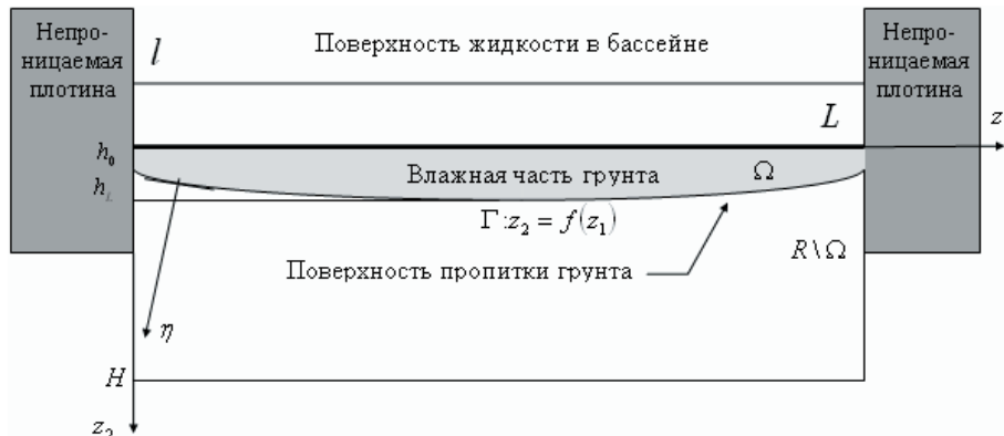
Рис. 1. Схема пропитки грунта под основанием бассейна
