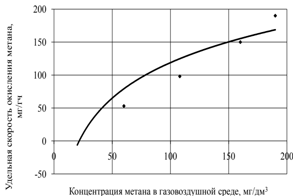
Рис. 3. Зависимость удельной скорости окисления метана от концентрации метана в газовой среде (модель уравнения 5)
