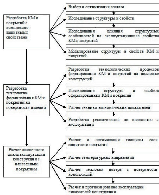
Рис. 1. Структурно-логическая схема этапов проектирования защитных конструкций ТТС перевозки и хранения опасных грузов
